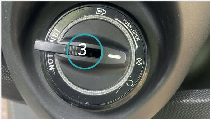
Ouvrez la sécurité de l'interrupteur principal (3) afin d'y insérer la clé.
