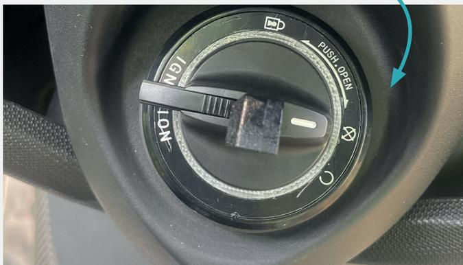
Une fois la clé insérée dans l'interrupteur principal, tournez le bouton dans le sens inverse des aiguilles d'une montre afin d'activer l'ouverture de la selle. Pour la première mise en route, placez le disjoncteur qui est situé sous la selle sur ON afin d'alimenter le véhicule.
