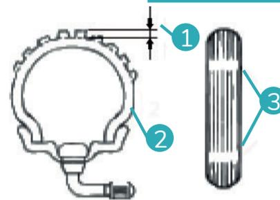
1. Profondeur des rainures des pneus
